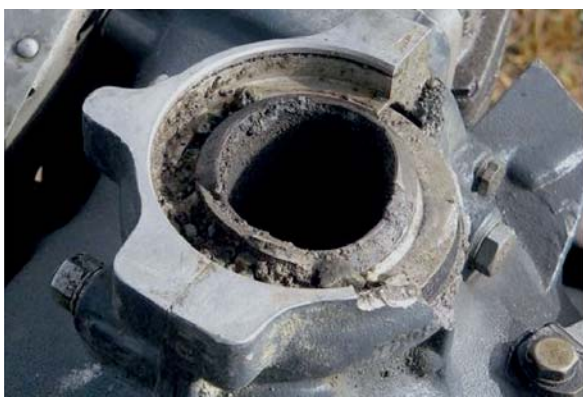
Foto n. 7: rottura albero dell'elica.
