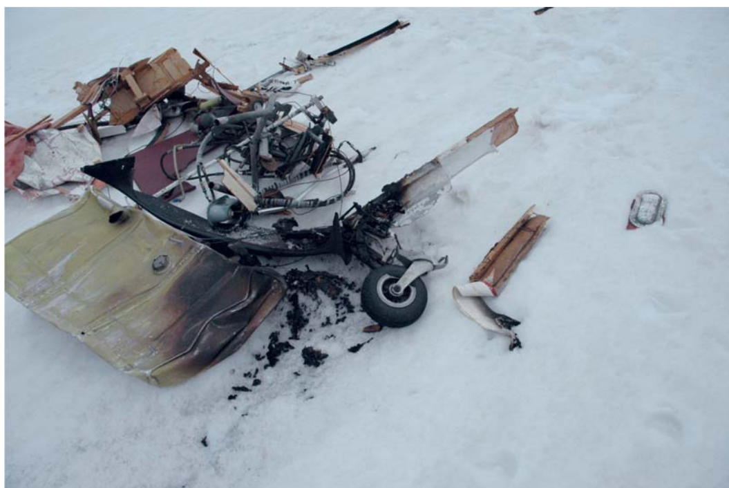
Foto n. 2: tracce di incendio in corrispondenza del serbatoio posteriore.
