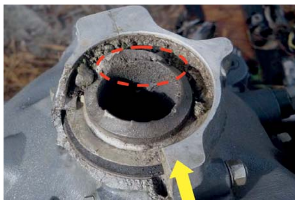
Foto n. 8: rottura albero dell'elica.
